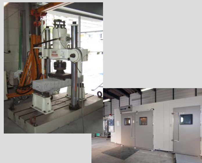
構造物の疲労耐久性を評価する試験機(上) -30℃から50℃までの条件を再現できる環境試験室(下)
