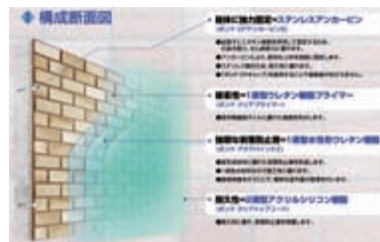
ボンド アクアバインド工法断面図
