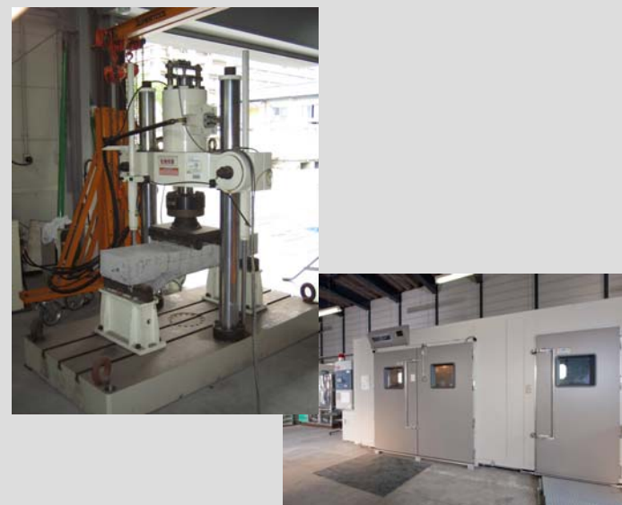
構造物の疲労耐久性を評価する試験機(上) -30°Cから50°Cまでの条件を再現できる環境試験室(下)
